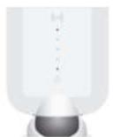
中间三个 LED 将连续闪烁，表示 Mesh Point 已准备就绪，可以进行配置。
