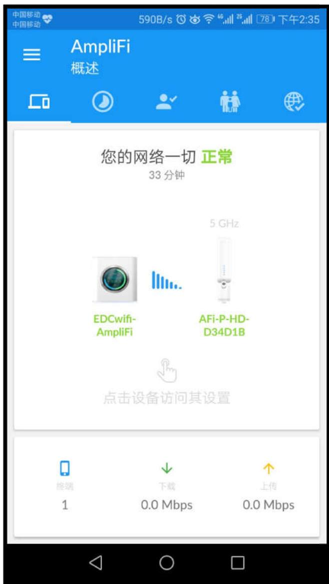
11. 点击扩展器图标，可进入查看扩展器信号，实际安装时可根据界面反馈的信号强度，调整扩展器天线的方向性，使其达到最佳效果，若实际环境遮挡物较多，MESH 信号较弱，建议将下图的中继频段选为 **2.4GHz-距离更远**
