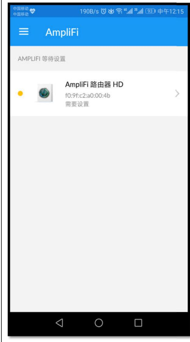
6.按界面提示，创建 wifi 的名字和密码，密码需要 8 位以上，下方按钮开启，则将 wifi 密码也设置为管理员登录密码，以登录路由器修改配置使用，点击继续，听到响声提示后则配置完成，请将手机重新连接到刚刚设置的 wifi
